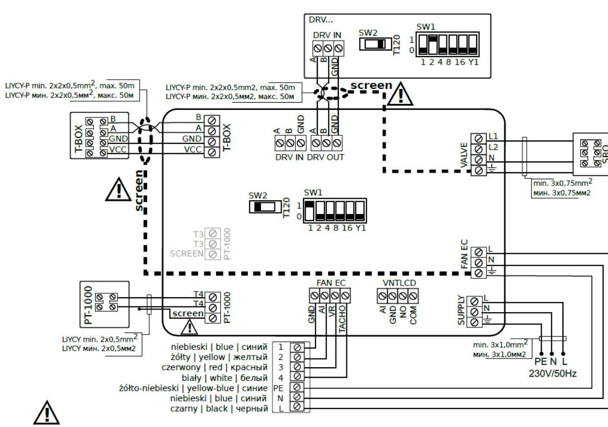
1. Ekrany przewodów komunikacyjnych podłączyć do zacisku PE | Connect the screens of the communication cables to the PE terminal | Экран соединяющих проводов подключить к зажиму PE.
